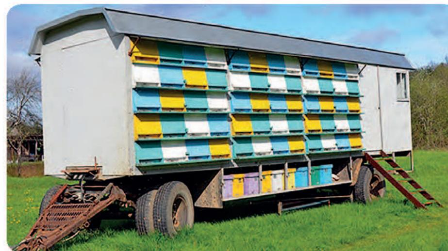
При конструюванні пересувної пасіки за основу береться рама зі сталевими стійками, прикріпленими до ресор. А до рами кріпяться з'єднані багатосекційні блоки для бджіл з магазинними надставками. Посередині облаштовується прохід для зручного обслуговування сесій з бджолами.
